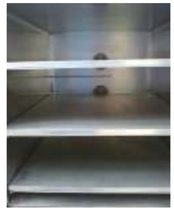
Ripiani fissi con riscaldamento diretto annegato nella fusione di acciaio inox
